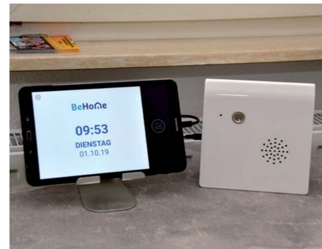
Die Schaltzentrale aller Signale ist das Wohnungs-Tablet. Hier werden alle Daten zu Gesundheit, offenen Fenstern oder dem Inhalt des Kühlschranks gesammelt. Über den weiteren Datenversand entscheidet der Mieter.
